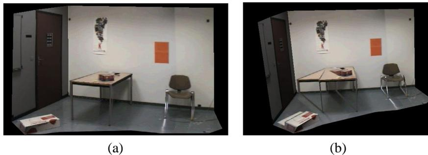
FIG. 3.6: (a) Modèle texturé construit avec *TotalCalib*. (b) Même modèle mais sous un autre point de vue. Cette image met en évidence que les textures sont dépendantes du point de vue.
