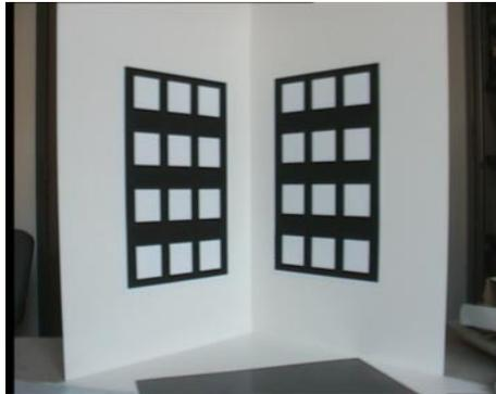
FIG. 3.7: Notre mire de calibrage, construite avec un socle en carton, sur lequel sont fixés deux schémas de grille.
