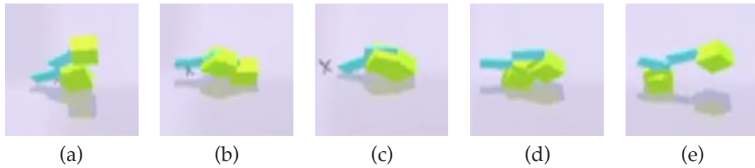
Figure 4.5: La créature bouge grâce aux blocs bleus qui sont en mouvement, ce mouvement est dû à l'action d'un signal sinusoïdal. La créature avance en prenant appui sur un bloc pour s'allonger (a-c) et puis se replie avant de s'allonger à nouveau (e-d).
